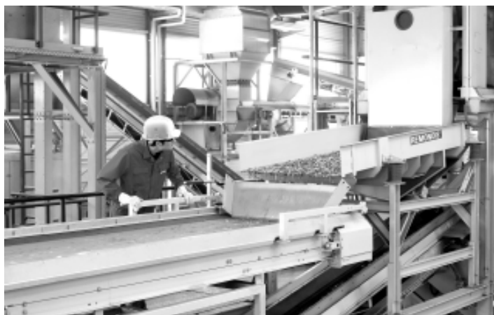
Nowoczesne instalacje REMONDIS do recyklingu zużytego sprzętu elektrycznego i elektronicznego pozwalają odzyskiwać czystą miedź także z małych urządzeń AGD.
