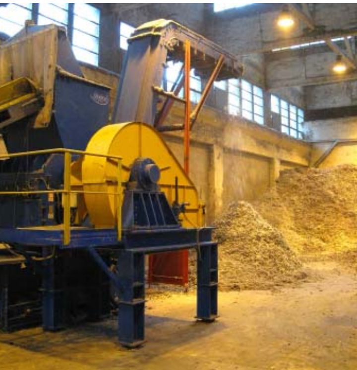
Muszą powstać nowe składowiska odpadów, takie które spełniają normy unijne, będą musiały powstać kompostownie, zakłady przeróbki odpadów na paliwo alternatywne. Na zdjęciu produkcja paliwa alternatywnego z odpadów komunalnych.
