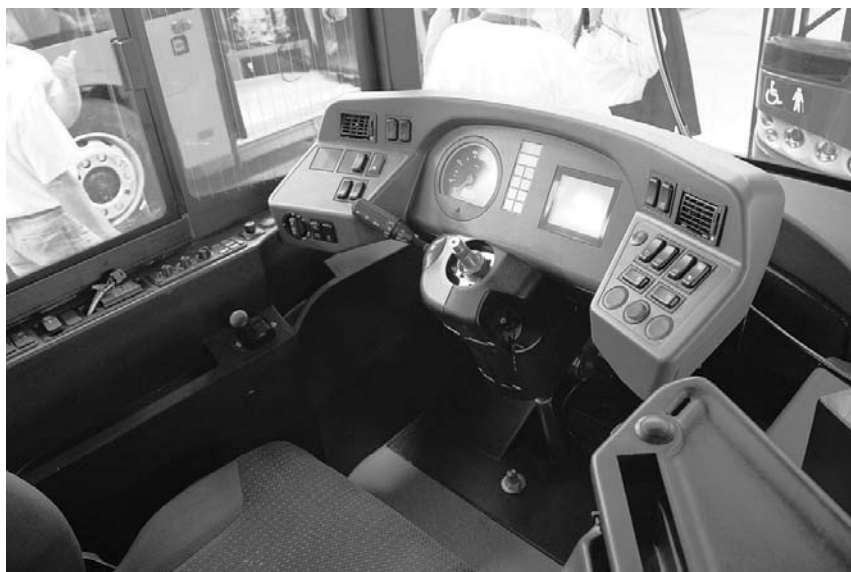
Deska rozdzielcza z wielkoekranowymi wyświetlaczami oraz układy sterowania jak w zwykłym autobusie (zdjęcie z linii produkcyjnej, zatem brak kierownicy to nie jest nowatorskie rozwiązanie, ale po prostu jeszcze nie została zamontowana).
