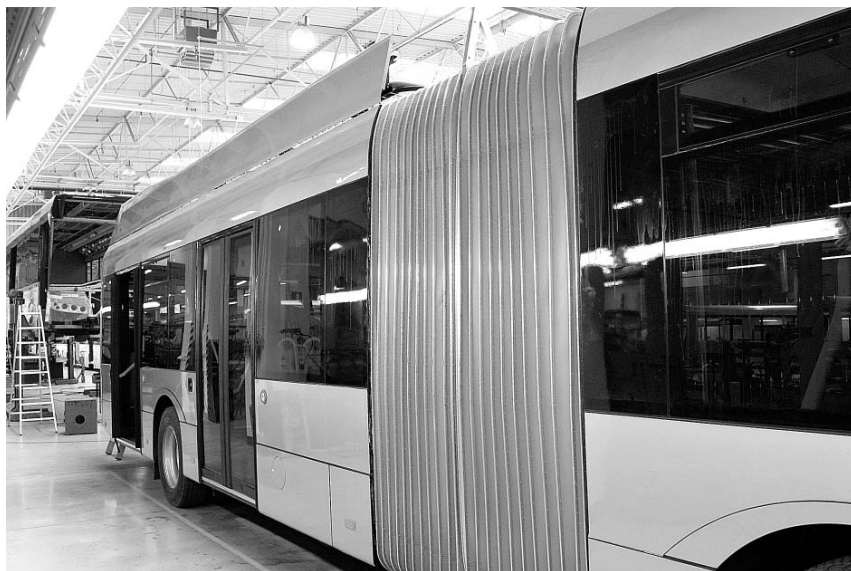
Energia odzyskiwana w trakcie procesu hamowania gromadzona jest w akumulatorach zamontowanych w widocznym na zdjęciu pojemniku na dachu autobusu.
