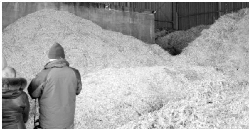
Magazyn paliwa – pociętych na kawałki gałęzi wierzby energetycznej – w kotłowni w Ryjewie, powiat Kwidzyn.
