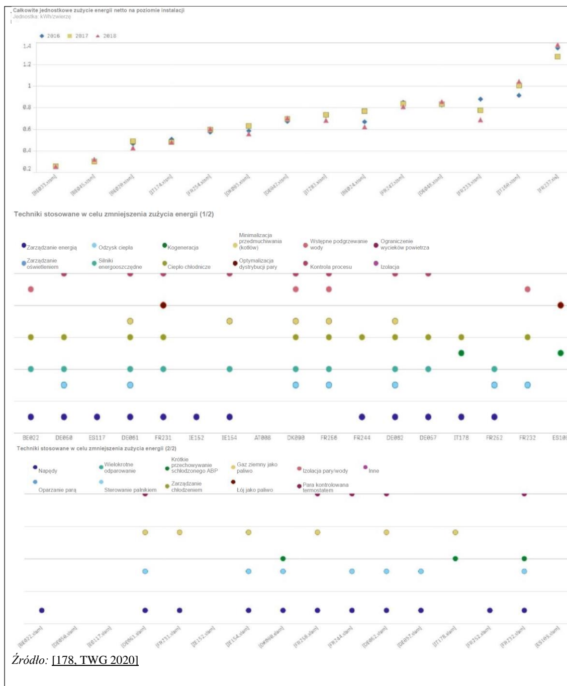
Rysunek 3.66: Jednostkowe zużycie energii netto (kWh/zwierzę) oraz stosowane techniki ograniczania zużycia energii w rzeźniach kurczaków (na poziomie instalacji)
