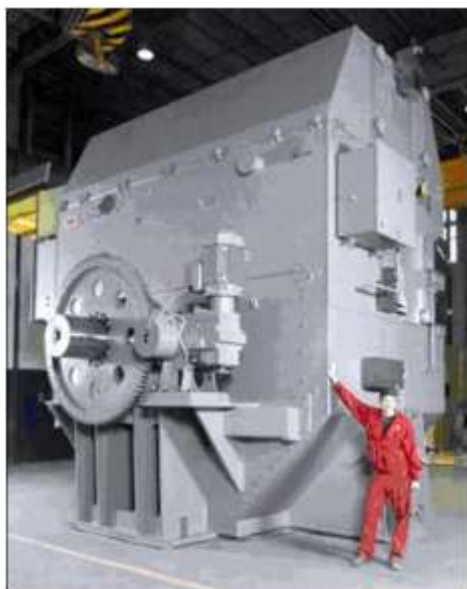
Rysunek 3.26: Silnik sprężarki o mocy nominalnej 24 MW [95, Savolainen, 2005]
