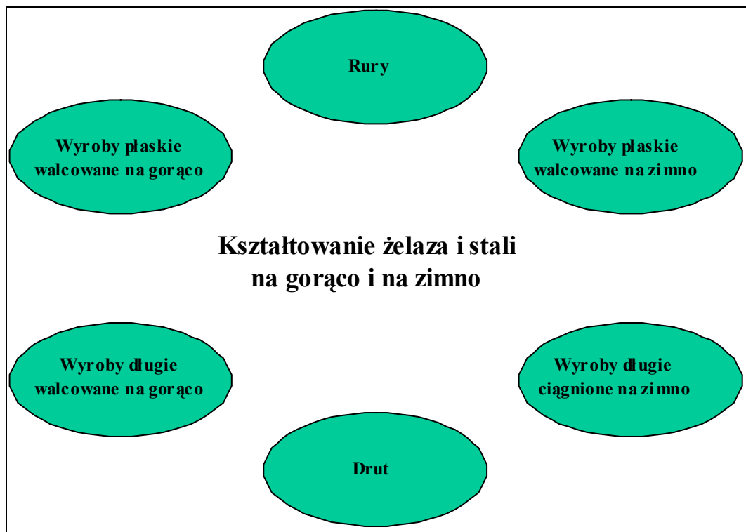
Rys. A.1-1: Wyroby kształtowane na gorąco i na zimno, objęte niniejszym dokumentem referencyjnym BREF
