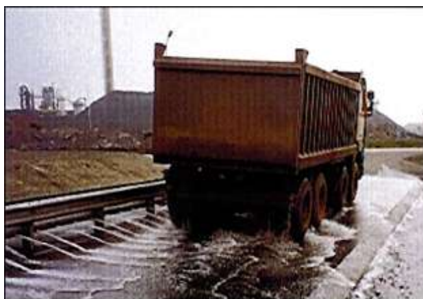
Rysunek 4.32: Basen z wodą w połączeniu z bieżącą wodą do roboczej powierzchni opon [134, Corus, 1995]
