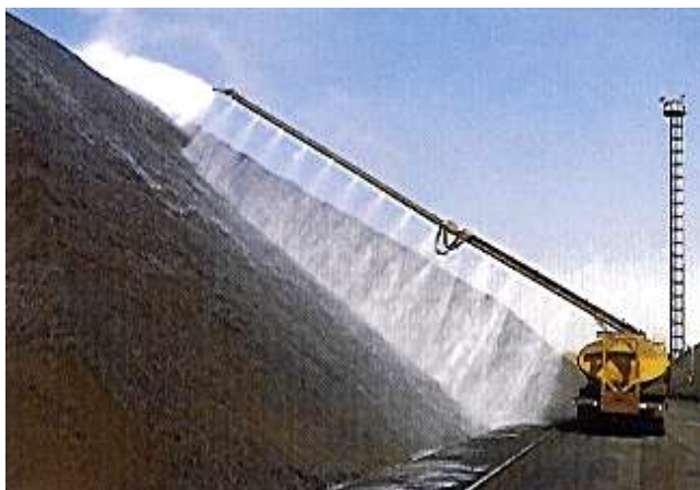
Rysunek 4.20: Jednolite rozpylanie jest niezwykle ważne dla kształtowania dobrej skorupy [134, Corus, 1995]
