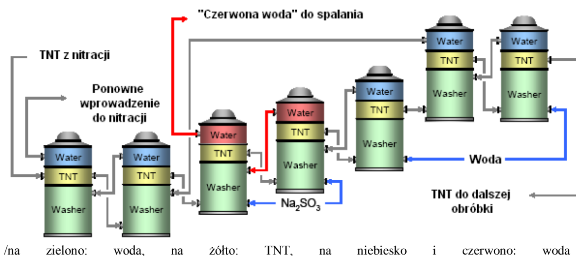
Rysunek 76. Przeciwprądowe mycie produktu w procesie wytwarzania TNT
