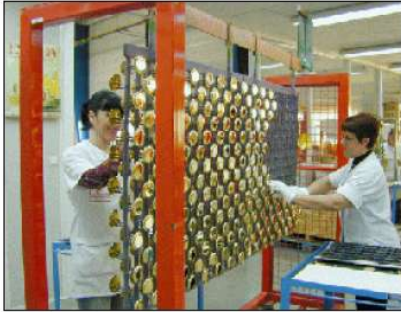
Rysunek 2.5: Umieszczanie w ramie: rozładunek gotowych komponentów/ Zawieszki lub stojaki: wypakunek skończonych komponentów
