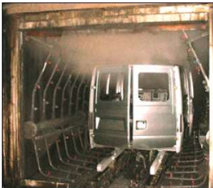
Rysunek 2.4: Urządzenie automatyczne poddawane natryskowej obróbce wstępnej (spray pre-treatment) [ACEA]
