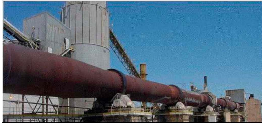
Rysunek 2.31: Przykład długiego pieca obrotowego używanego w przemyśle wapienniczym [44, EuLA, 2006]
