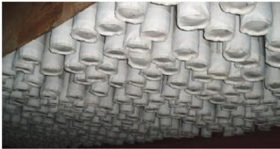
Rysunek 1.60: Przykład filtra tkaninowego i materiału filtrującego wykorzystanego w zakładzie cementowym w Zjednoczonym Królestwie [82, CEMEX Rugby Zjednoczone Królestwo, 2006]
