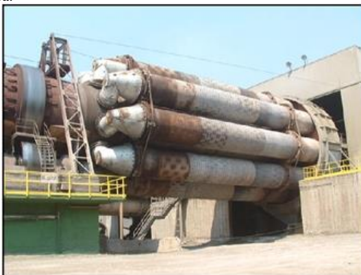
Rysunek 1.18: Przykład chłodnika planetarnego [45, Schorcht, 2006], [90, Węgry, 2006]
