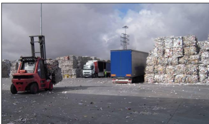
Rysunek 6. 30 Składowanie makulatury na zewnątrz, na powierzchni utwardzonej betonem
