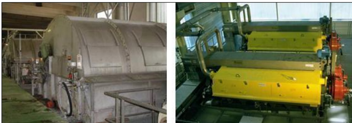
Rysunek 4.6 Przykładowy filtr do płukania (z lewej) i instalacja do mycia i prasowania (z prawej) podczas procesu mycia masy celulozowej
