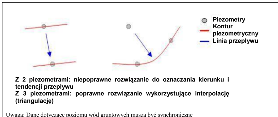
Rys. 8.7: Dobra praktyka oznaczania kierunku przepływu
