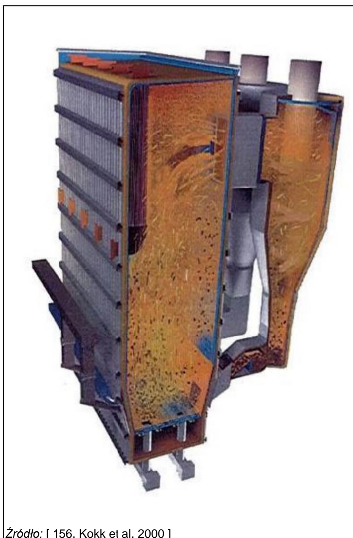
Rysunek 5.42: Przepływ paliwa i materiału złoża w opalonym biomasą kotle ze spalaniem w cyrkulacyjnym złożu fluidalnym
