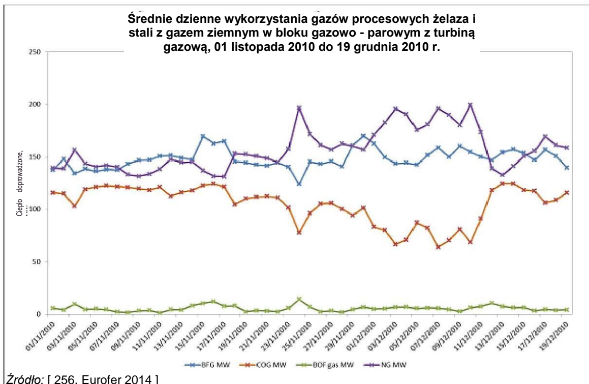
Rysunek 7.42: Średnie dzienne ciepło doprowadzone gazów procesowych żelaza i stali z gazem ziemnym i całkowite ciepło doprowadzone do bloku gazowo - parowego z turbiną gazową w okresie 50 dni
