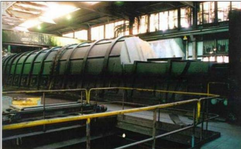
Rysunek 3.21: Osłonięta taśma spiekalnicza zgodnie z procesem EOS
