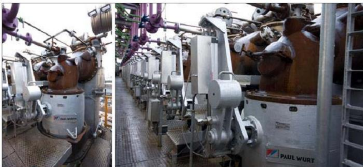
Rysunek 11.5: Zawory SOPRECO Model 2 w zapieczętowanej, załadowanej baterii
