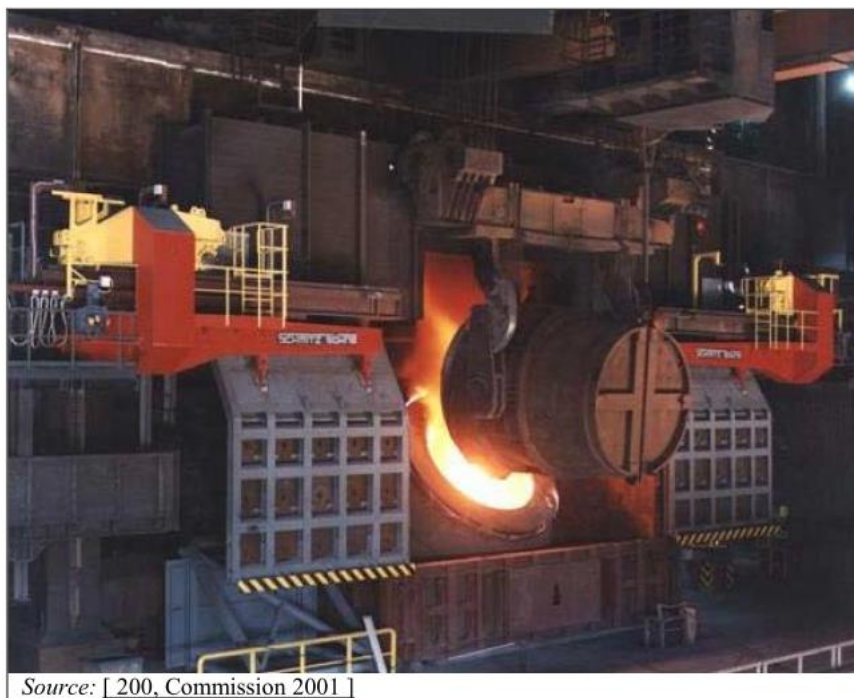
Rysunek 7.1: Zasadowy konwertor tlenowy w momencie ładowania surówki
