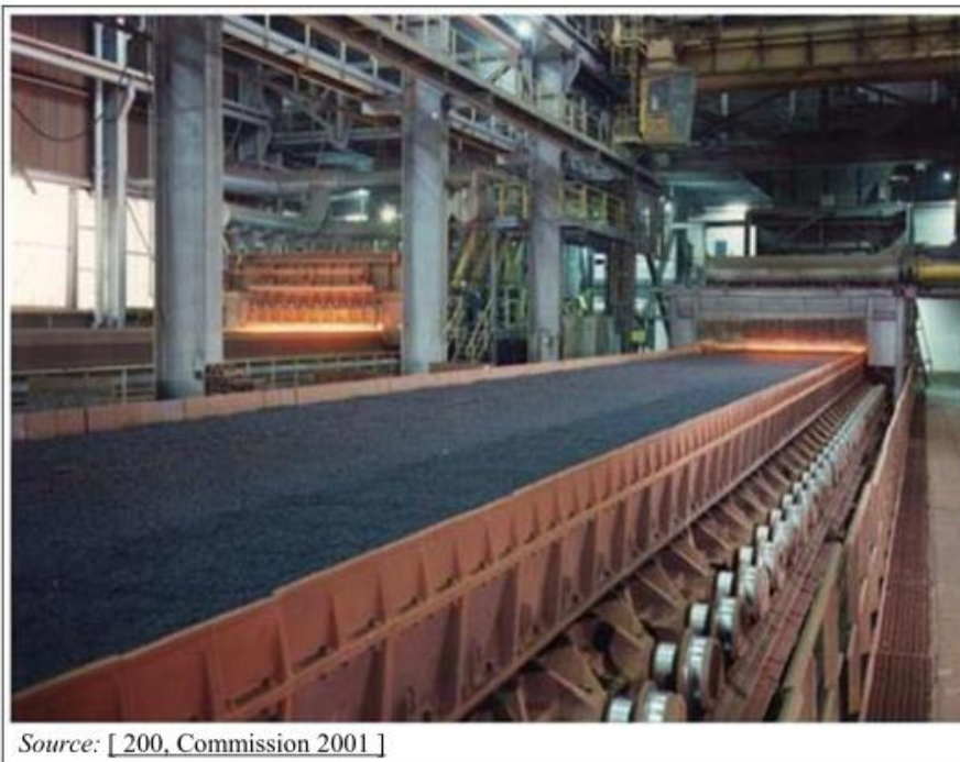
Rysunek 3.1: Zdjęcie taśmy spiekalniczej z urządzeniem załadunkowym (bębny lub rury zasypowe) i okapem zapłonowym na końcu wejściowym
