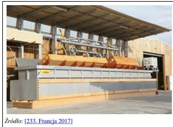
Ilustracja 15-5 Przykład krótkiego zanurzenia (krótkotrwałego zanurzenia / czasowego zatapiania) - zbiornik umożliwiający jednoczesną obróbkę kilku zestawów, zamocowanych na stojakach obok zbiornika zanurzeniowego.
