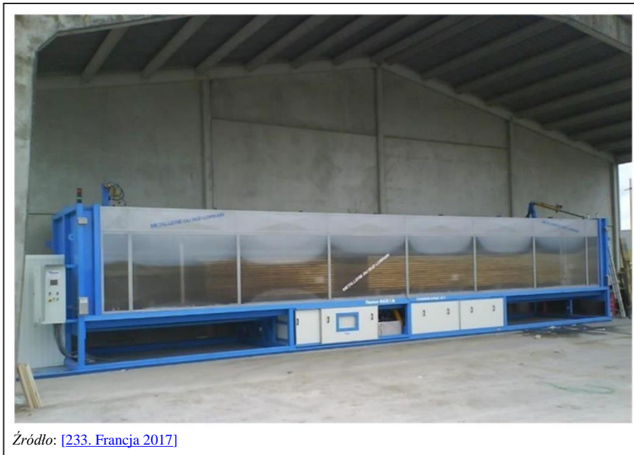
Ilustracja 15-7 Drewno w zamkniętym tunelu natryskowym.
