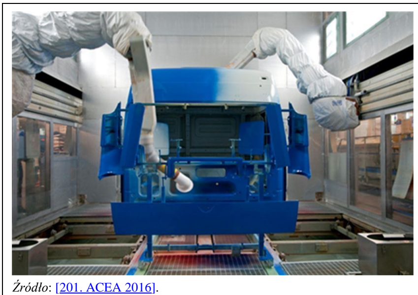
Ilustracja 2-14 Malowanie kabin samochodów ciężarowych.
