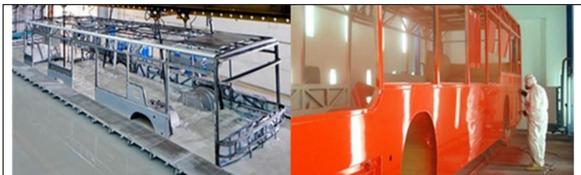
Ilustracja 2-16 Operacje powlekania autobusów: elektroforetyczne (po lewej) i nawierzchniowe (po prawej).
