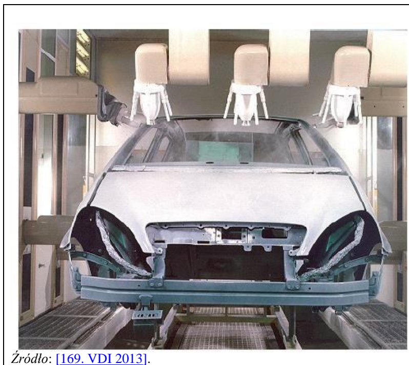
Ilustracja 2-40 Zautomatyzowane nakładanie farby za pomocą maszyn do malowania.
