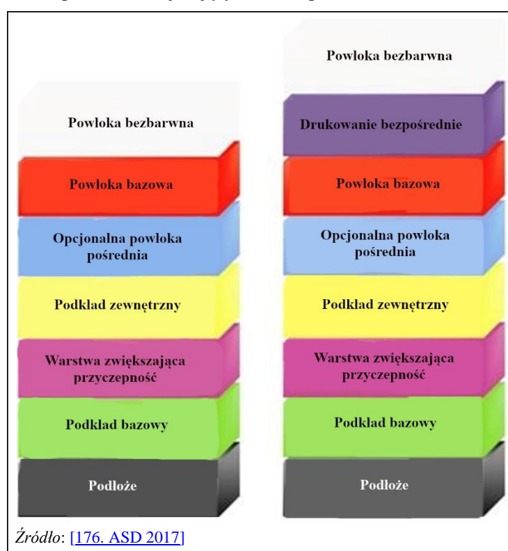
Ilustracja 5-11 Porównanie systemu BCCC ( powłoka bazowa - BC / powłoka bezbarwna - CC) z drukiem bezpośrednim w BCCC.
