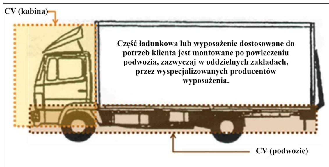
Ilustracja 2-12 Typowa konstrukcja samochodu ciężarowego (oddzielne przedziały dla kierowcy i ładunku).
