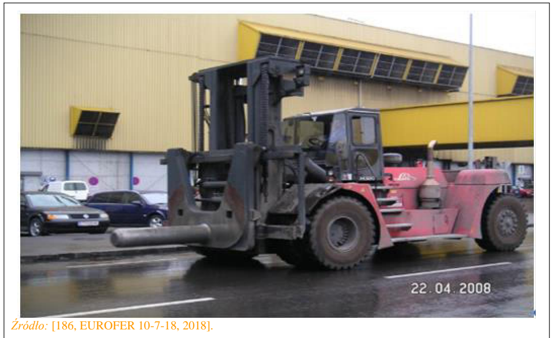
Rysunek 8.6: Zwijarka z trzpieniami do manipulacji i transportu kręgów
