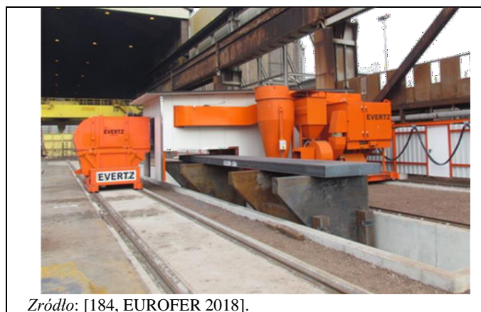
Rysunek 2.75: Szlifierka wyposażona w system oczyszczania gazów odlotowych w Tata Steel IJmuiden
