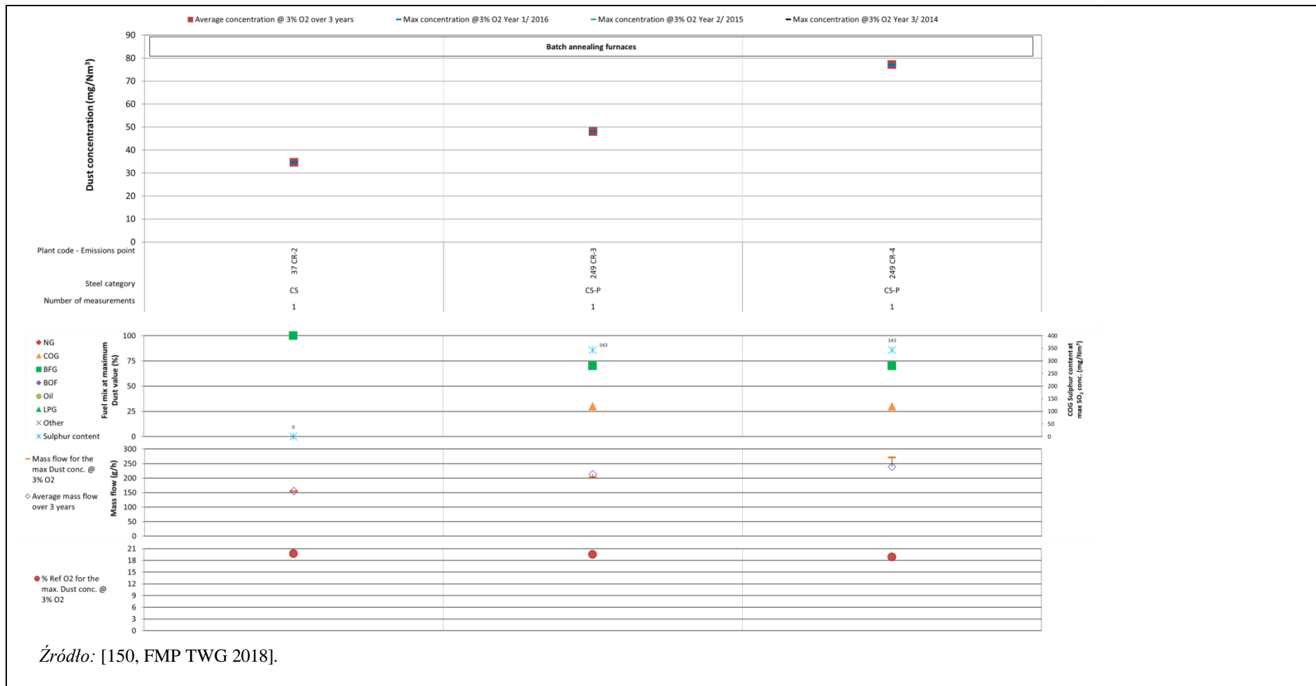
Rysunek 3.36: Emisje pyłu z ogrzewania materiału wsadowego (w mg/Nm 3 przy 3 % zawartości tlenu) dla paliwa innego niż 100 % gazu ziemnego
