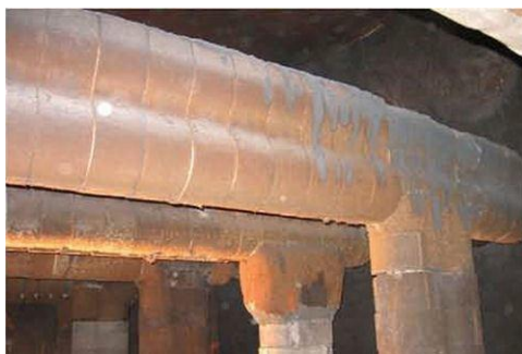
Rysunek 2.86: Konstrukcja płozy dwururowej dla pieców grzewczych
