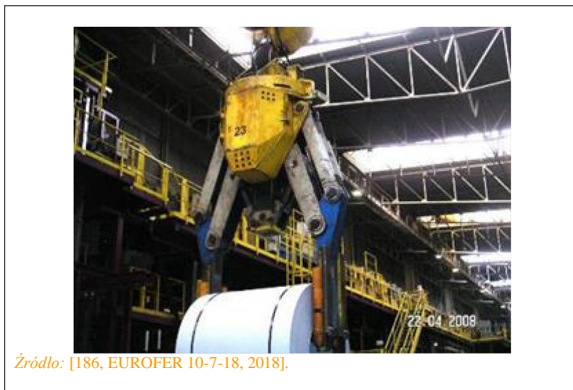
Rysunek 8.4: Kleszcz zwojowy z osłoną
