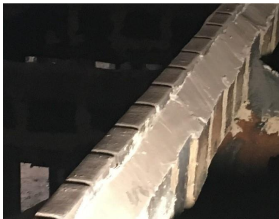
Rysunek 2.85: Konstrukcja płóz w piecu grzewczym przed walcowaniem na gorąco
