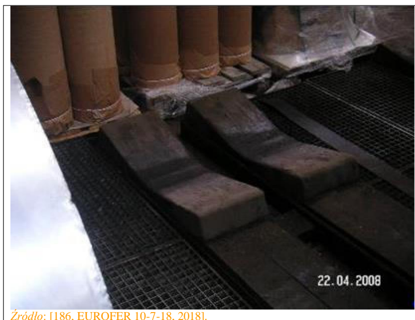
Rysunek 8.3: Podpora wężownicy z wannami ociekowymi oleju
