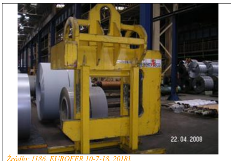
Rysunek 8.5: Magnes z hakiem C do podnoszenia cewek
