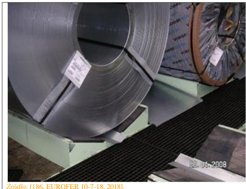
Rysunek 8.2: Wspornik cewki wyłożony gumą odpowiadającą geometrii cewki
