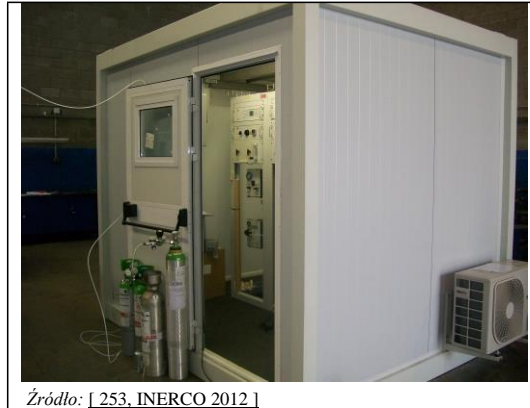
Ilustracja 4.3: Przykład klimatyzowanej obudowy dla AMS
