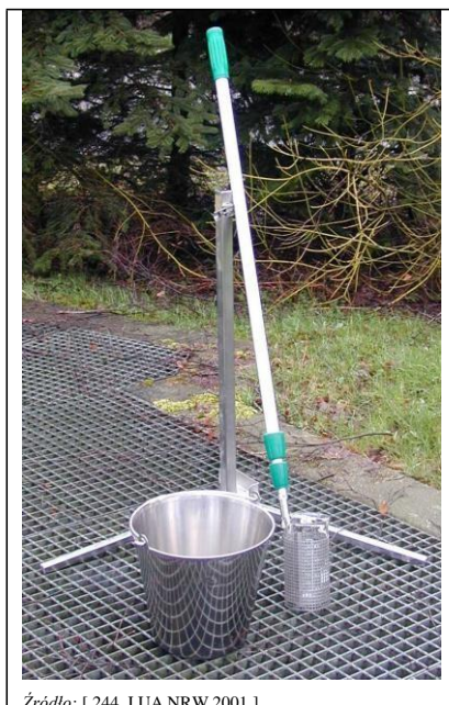
Ilustracja 5.2: Przykład czepaka probierczego z uchwytem
