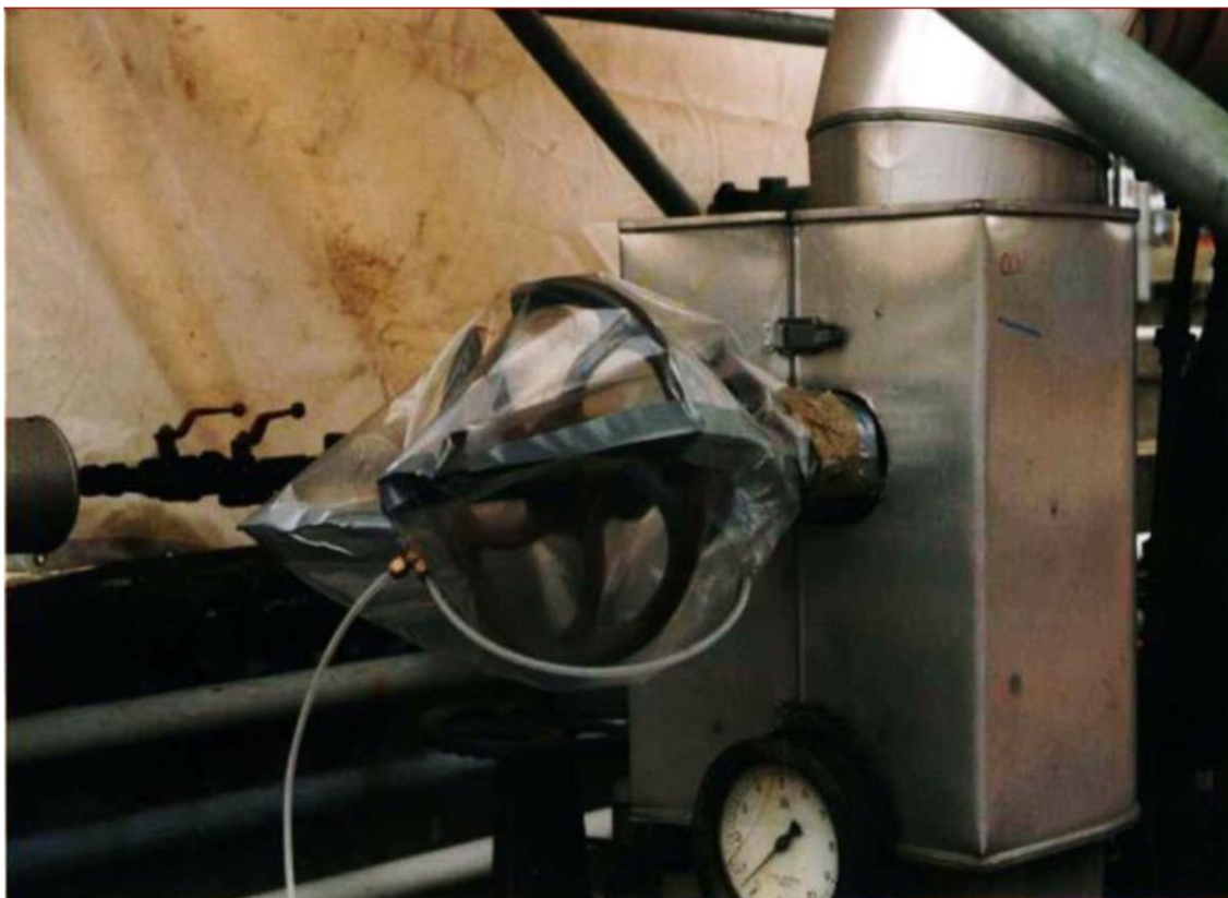
Rysunek 3.58: Warkowanie nieszczelnego zaworu
